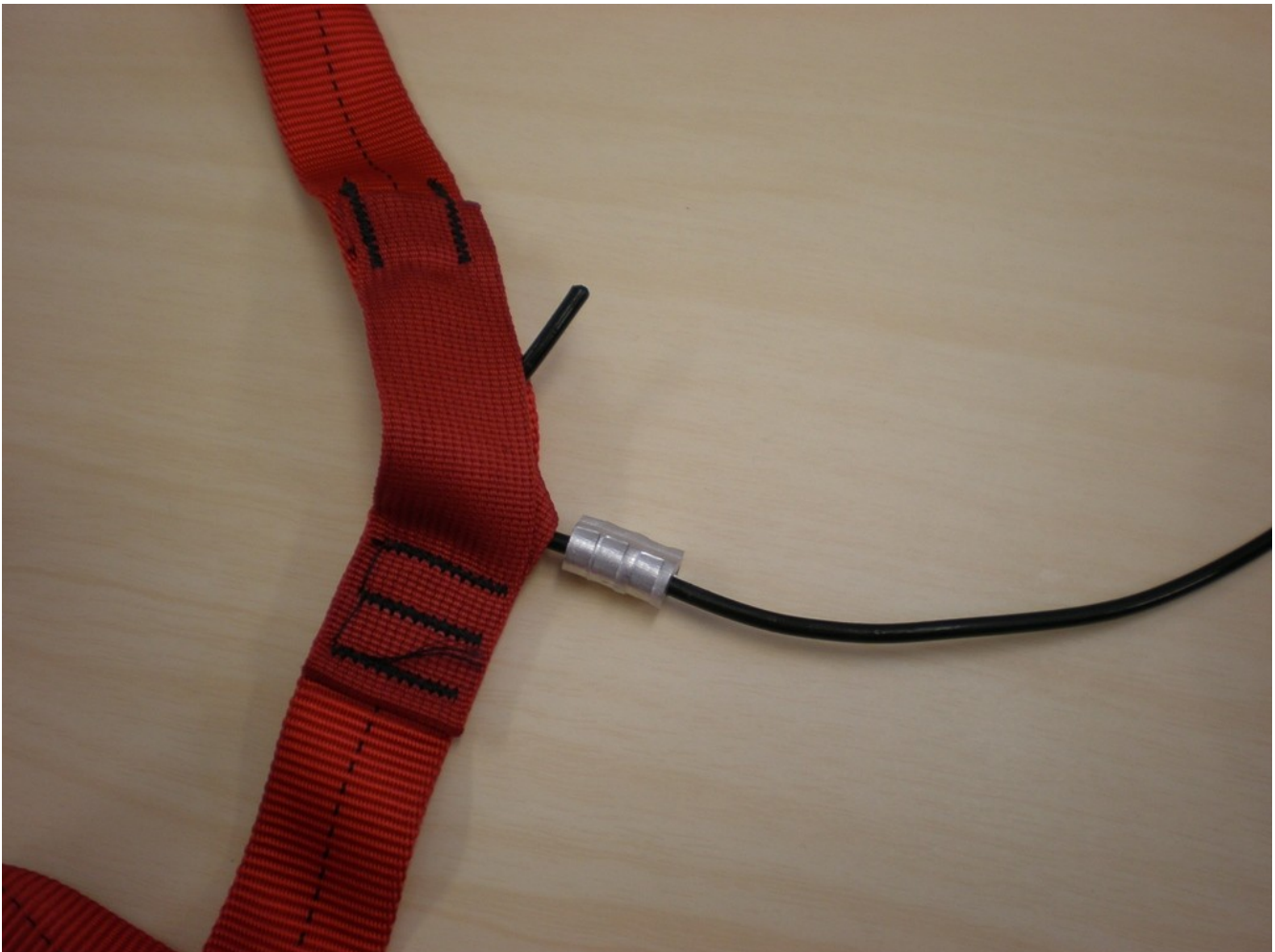
Kuva 1. Kuvassa vaijeripinni on luistanut kiinnitysholkista ulos
